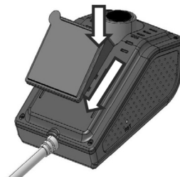
Установка устройства на кронштейн
